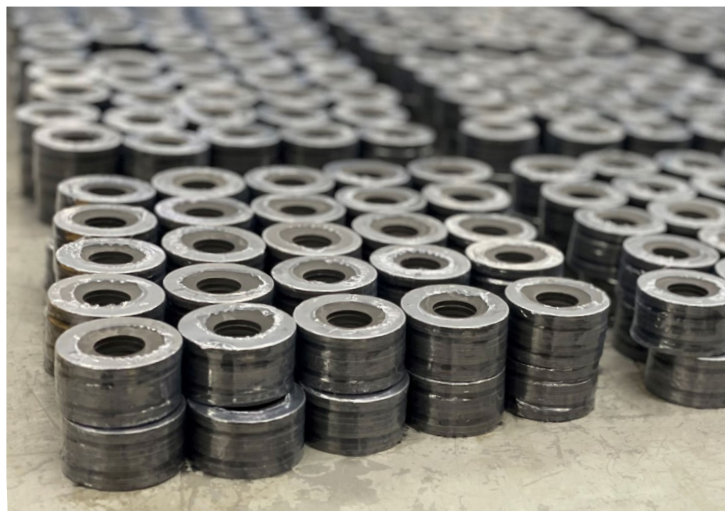
Zmontowane stosy sprężyn talerzowych SPIROL są gotowe do montażu
